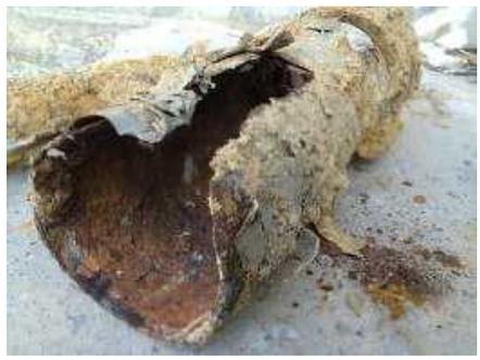
劣化により腐食・破損した排水管
