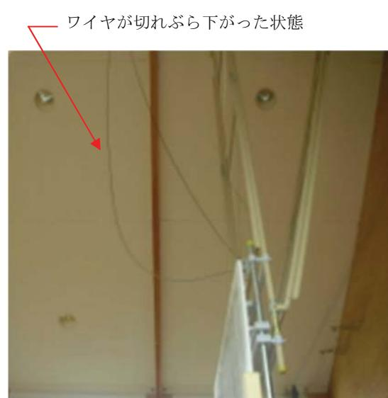
写真付 1.2.7 : ワイヤの劣化・損傷例<sup>18)</sup>
