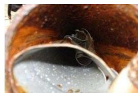
内面ライニングが剥離し、脱落した状況
