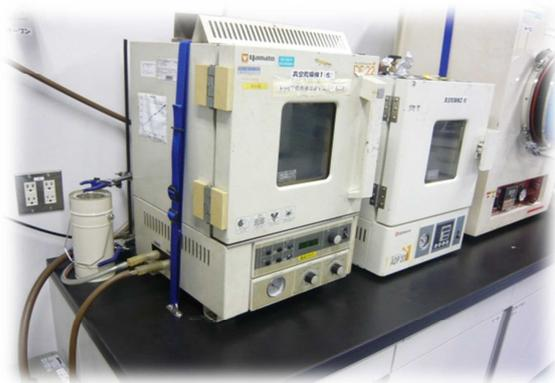
写真9 転倒防止のため，ロープで固定している実験装置の例
