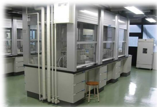
写真10 有害ガス等のばく露防止のため、排気フードで覆っている実験台の例
