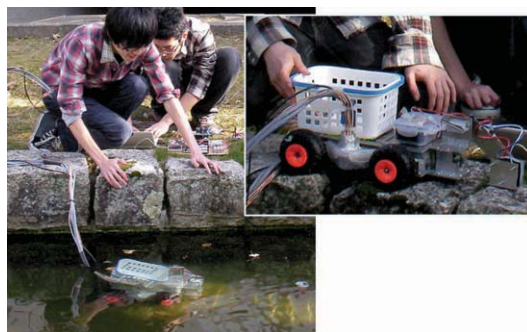
写真3 空き缶回収ロボットの水中動作実演
