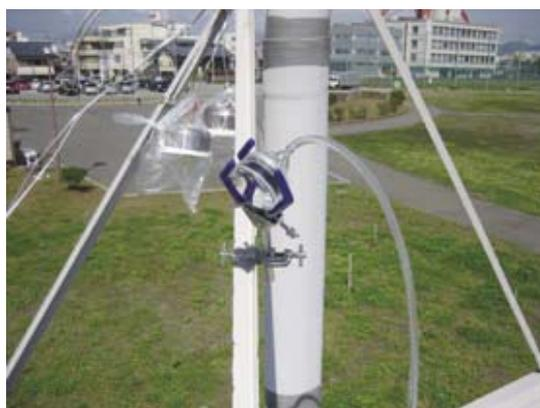
写真 飛来物質用簡易装置による捕集(福井市)
