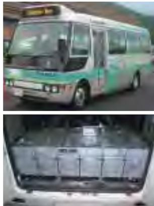
図4 電気バスとリチウムイオン電池
