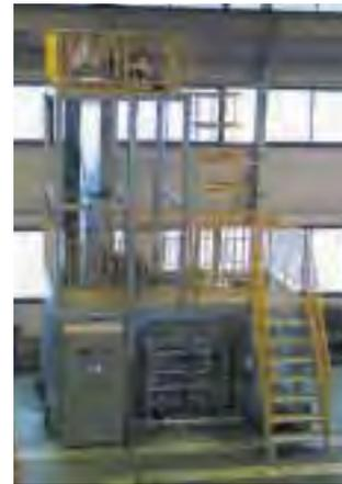
図1 火炎式噴霧熱分解製造装置
