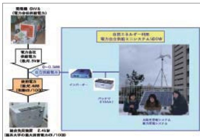
具体的には、提案する自然エネルギー利用電力自立供給システムの1/1000規模のミニシステムを実験室内に構築し、このミニシステム上で電力自立供給の基盤となる制御技術を創出するとともに、電力自立供給システムの有用性を経済性と環境負荷低減の観点から定量的に評価している。
