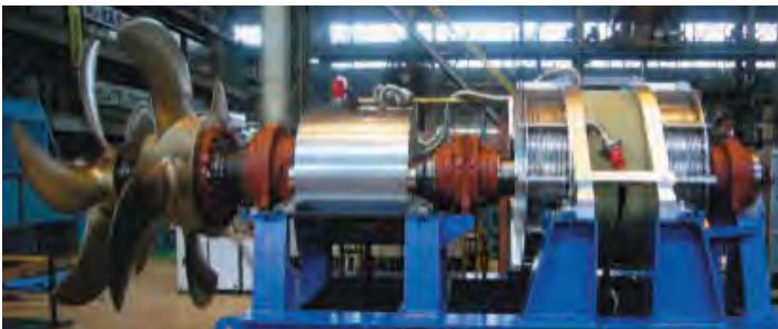
液体窒素冷却超電導モータを用いた船用2重反転プロペラ推進装置
