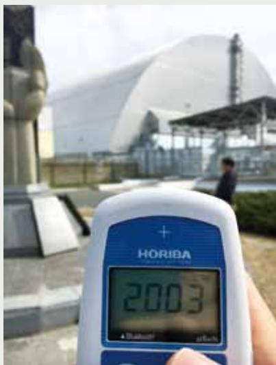
図.事故で損傷した原子炉を封じ込めるための構造物である「新安全閉じ込め構造物」前での空間線量率計測。敦賀市ではおおむね毎時0.06マイクロシーベルトのところ、観光客の立ち入り可能なこの場所では毎時2.00マイクロシーベルトであった。（2019年9月チヨルノビリ原発前にて撮影）
