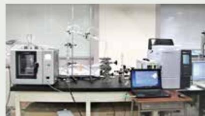
図1.電磁波によるプラスチックの分解装置
