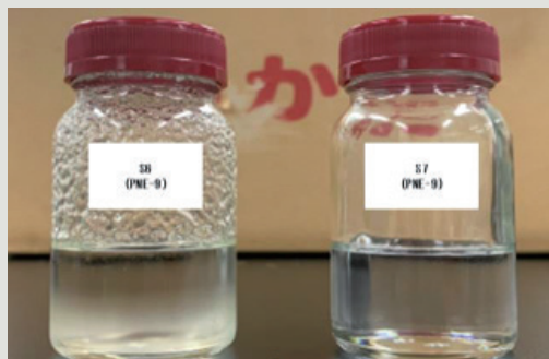
図4 開発中の液体シンチレーター (右がリチウム添加型シンチレーター)
