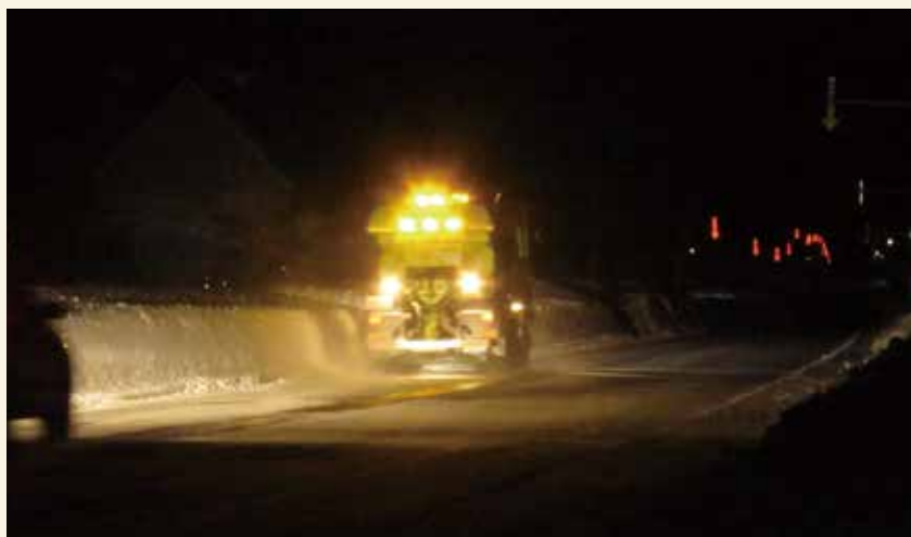
写真1 凍結防止剤の散布状況
