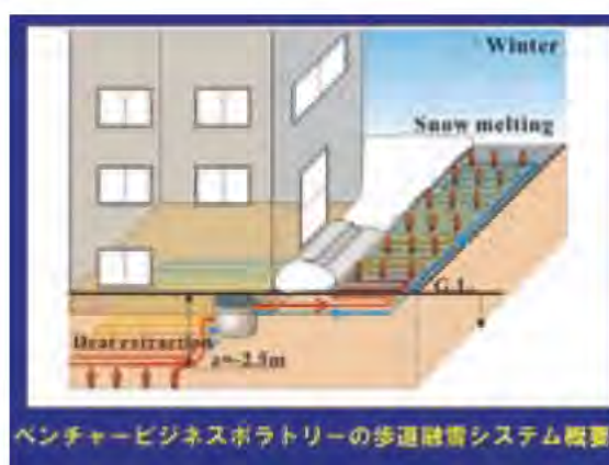
図-2 福井大学ベンチャービジネスラボラトリー歩道融雪システム
