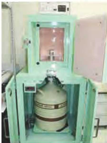
ガンマ線測定装置を開けた様子
