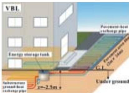
Fig.1 建物基礎地中熱採集 (SGHC) システム
